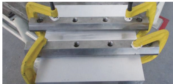
图 1 试件焊接工装及装配情况
